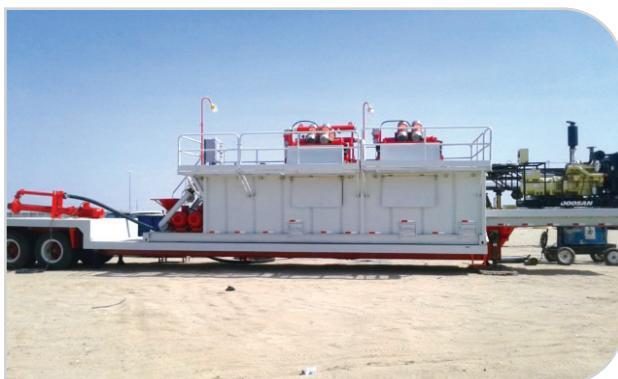
Система регенерации бурового раствора бурения водяной скважины
