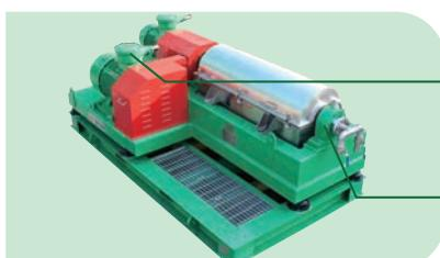
Два двигатели установится в одной головке, компонтная конструкция, чтобы не часто изменять ремни, и больше места для обслуживания
