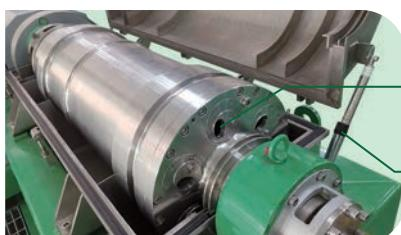
Легко регулировать высоту на выходе жидкости для гибкого применения.
