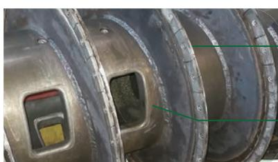
Шнек с установлением карбидных вольфрамовых сплавом, его срок службы лучше чем с покрытием. И все кусуки простоты при смене
