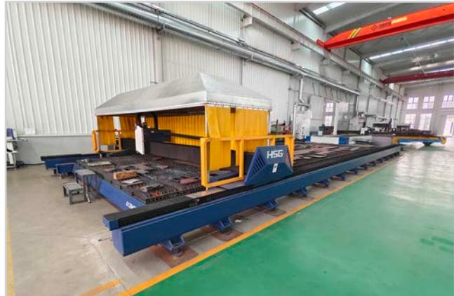
Большой станок для лазерной резки с ЧПУ
